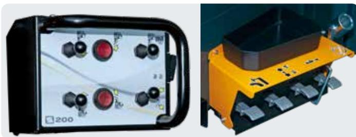
**Consola mandos multifunción** que contiene todos los mandos de trabajo. Ideal para el destalonado dinámico y por la posibilidad de realizar el match mounting entre neumático y llanta, gracias a los dos discos de doble mando. Los pedales laterales tienen una dimensión mínima y ofrecen eficiencia operativa. Ahora disponible con el pedal adicional para el bloqueo de la rueda.
