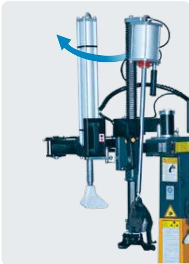
El prensa talón, de serie, es **muy útil con los neumáticos más difíciles**, durante las fases de desmontaje y montaje. Está siempre al alcance de la mano gracias al sistema de retención que lo conecta con el brazo automático de apertura lateral.
