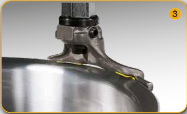
**FR** → 3•**Outils de montage** avec le nouveau profil adaptable à les nouveaux jantes et pneus. **Protections en plastique interchangeables** pour protéger les jantes en aluminium pendant les montage/démontage.
