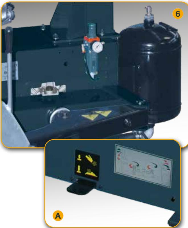
**FR** → 6•Dans les versions **GP**, le **réservoir d'air** pour le système de gonflage tubeless, de **grande capacité** (16 litres) est construit en conformité avec la norme EN selon la directive CEE 87/404/CEE. La pédale pour le gonflage tubeless est positionnée sur la partie latérale de la machine (**A**), pour ne pas être déclenchée par inadvertance.
