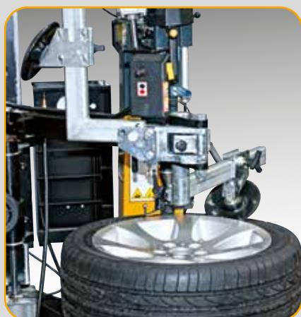
**FR** → • **Montage «SANS CONTACT»:** le pousse-talon PT permet de monter n'importe quel type de roue sans aucune griffe.
