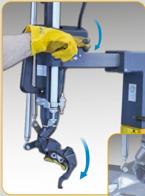
**FR** → • **DÉMONTAGE “LEVERLESS”:** bec de démontage «leverless» facile et sûr; une simple commande pour activer le système «leverless».
