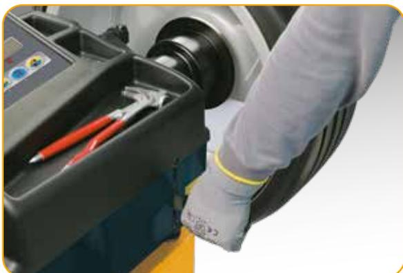
**FR** → **Frein de stationnement** Facilite les opérations de blocage et de déblocage de la roue et l'application des contre-poids. Le levier, dans les versions motorisées, permet également le fonctionnement du moteur de lancement à 100 trs/min.
