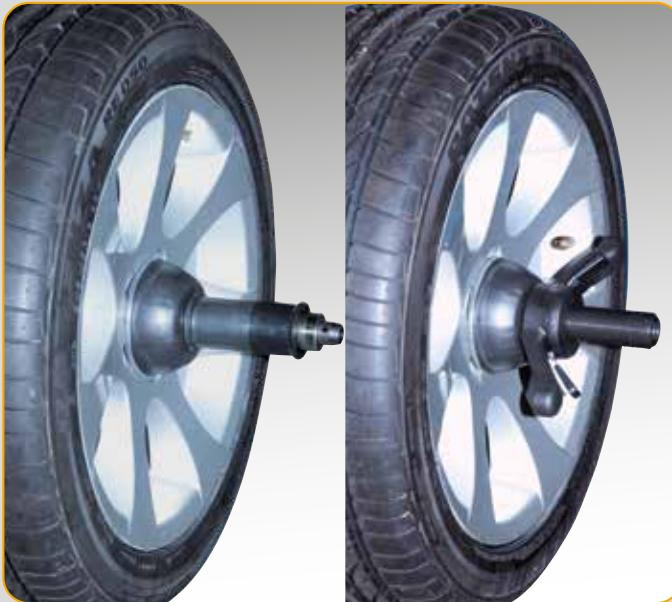
**FR** → • **BLOCAGE** Nouveau système automatique de blocage de la roue, à couple constant, qui réduit les temps de travail et augmente la précision du centrage (**S 65EC** et **S 63EC**) ou blocage manuel de la roue avec frette à clip (**S 65E** et **S 63E**).
