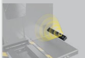
8-21100300/90_RRS-W Radial Runout Sonar Wheel para a medição da excentricidade radial do pneu
