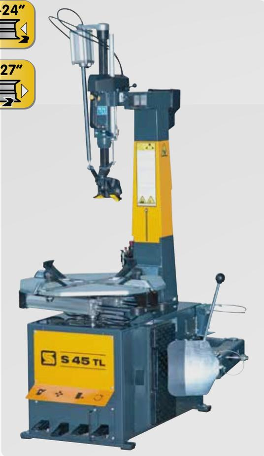
**Arbeitskopf mit Demontagetechnologie „Montiereisenlos“**
